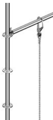
Fig. 5: Anslutning till ett horisontalstag. (OBS! EJ tillåtet på Alu-Allround enl. fästpunkt 10).
