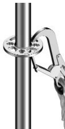
Fig. 4: Anslutning i kranens samtliga hål är möjligt. (OBS! EJ tillåtet på Alu-Allround).
