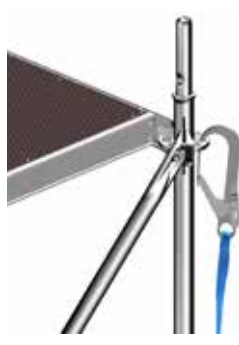
Fig. 3: Fästpunkt 2a (i kransen över huvudhöjd på färdigmonterat bomlag).
