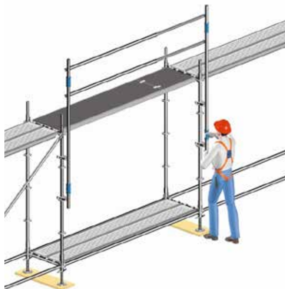
Fig. 4: Detaljförstoring: Montering av Layhers Montageräcke.
