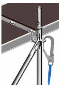
Fig. 2: Fästpunkt 2 (i kransen på bomlagnivå, endast i färdigmonterade bomlag. Endast för sele utan töjning).
