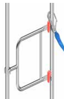
Fig. 5: Fästpunkt 4 (på spira, ovan gavelräckets övre fäste. OBS! gavelräcket måste vara monterat).
